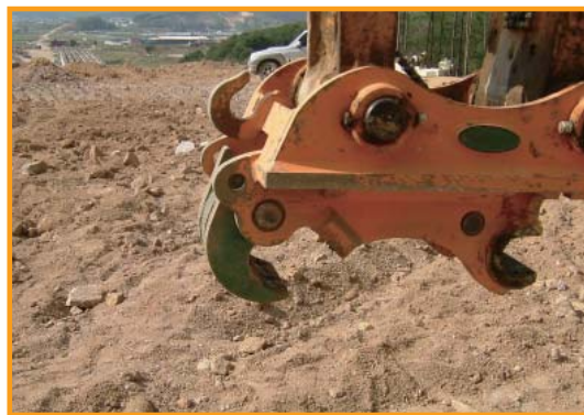
〈퀵 커플러가 젖혀져 버킷이 탈락된 모습〉
