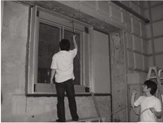
[그림 11] 음향인텐시티 측정
