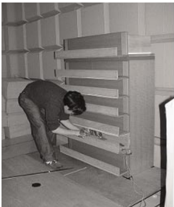
[그림 11] 음향인텐시티 측정
